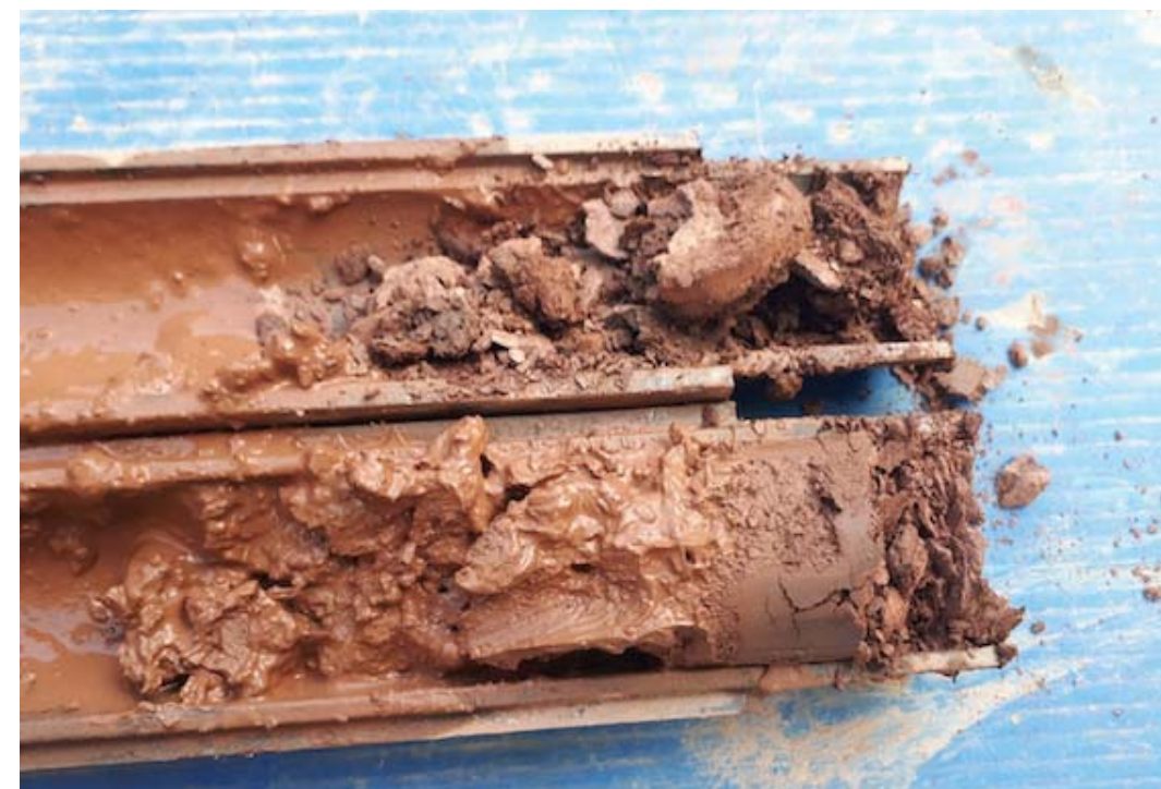
Fotografia de recuperació del portatestimoni de l'assaig de penetració estàndard SPT-2 realitzat in situ en el sondeig S-3 a la fondària d'1,2 m a 1,3 m.
