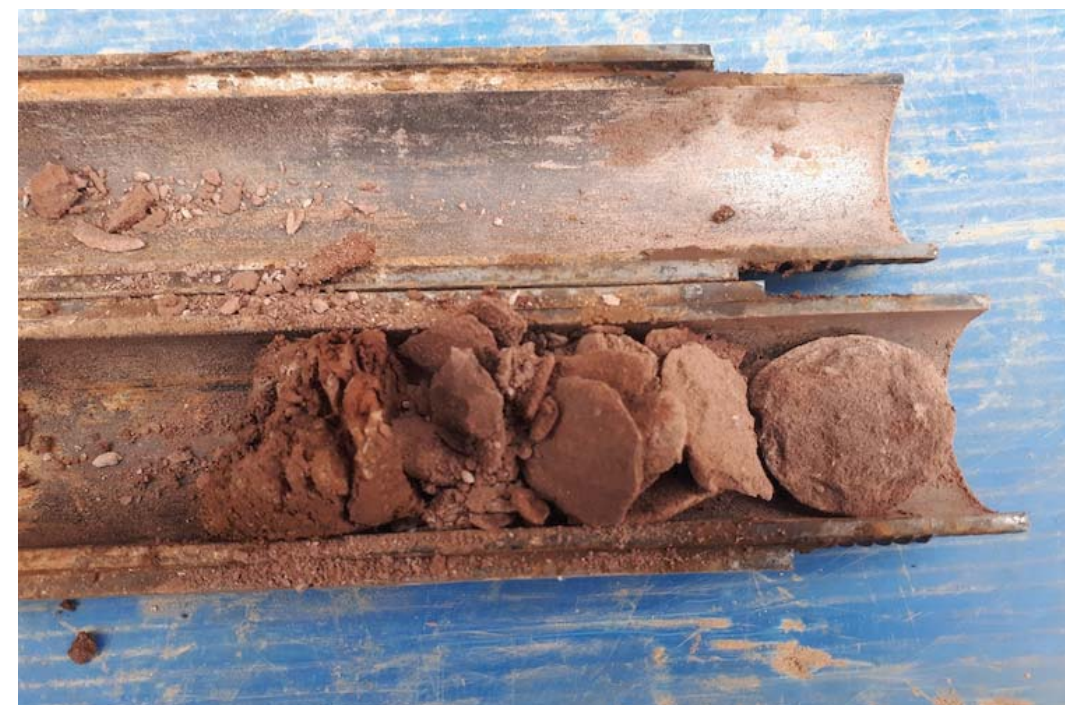
Fotografia de recuperació del portatestimoni de l'assaig de penetració estàndard SPT-1 realitzat in situ en el sondeig S-2 a la fondària de 0,80 m a 0,90 m.
