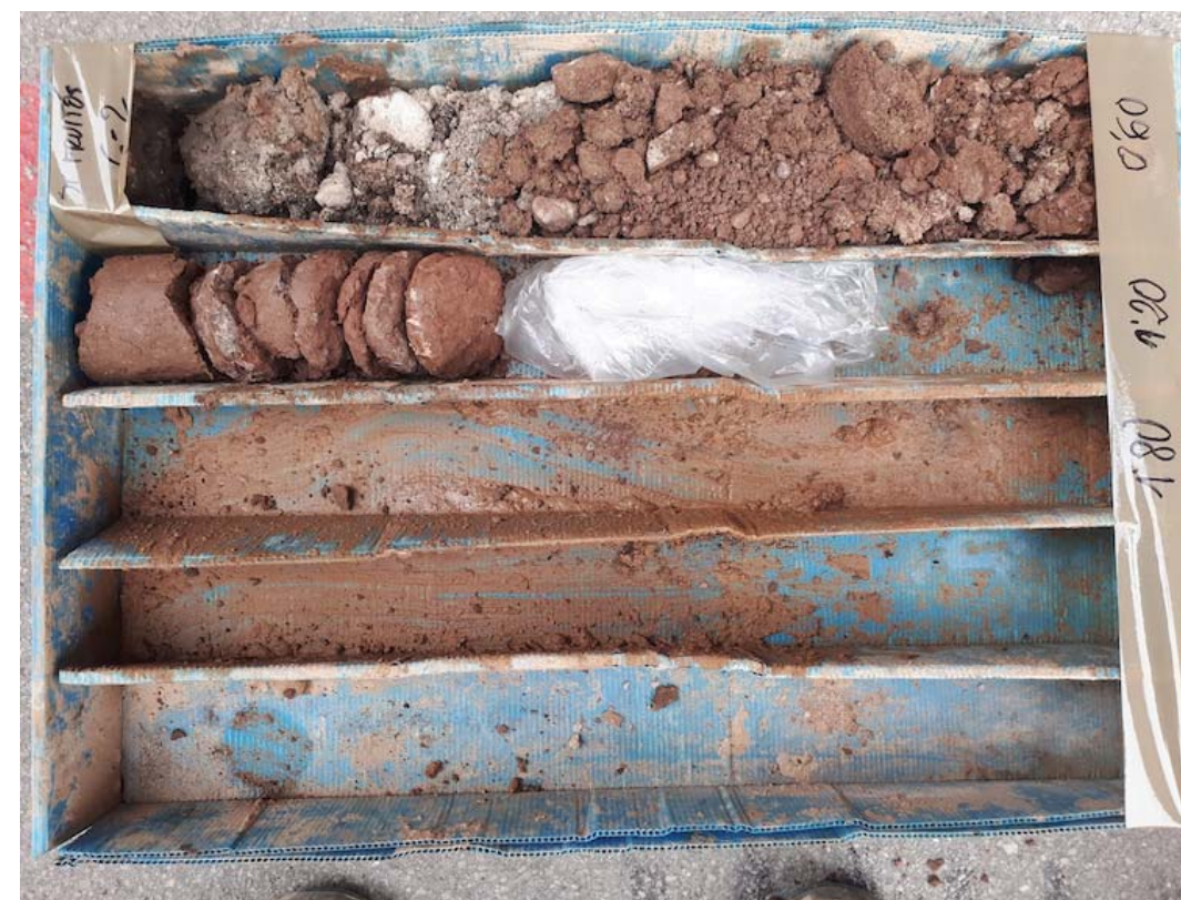
Fotografia de la caixa de recuperació del testimoni de sòl del sondeig S-2 fins a localitzar el substrat.
