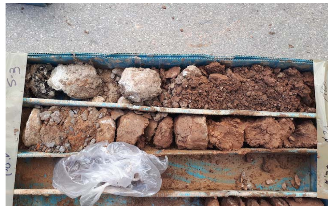
Fotografia de la caixa de recuperació del testimoni de sòl del sondeig S-3 fins a localitzar el substrat.
