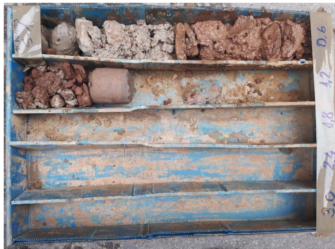
Fotografia de la caixa de recuperació del testimoni de sòl del sondeig S-1 fins a localitzar el substrat.
